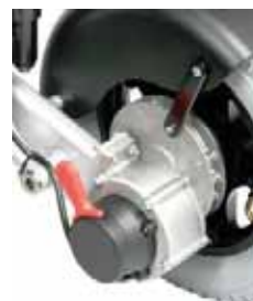
Moteurs débrayables dans chaque axe de roue arrière
