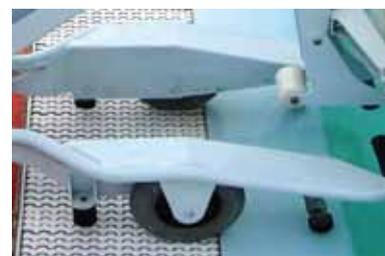
Tampons en caoutchouc automatiques escamotables, entre les roues avant et arrière qui évitent à la machine de basculer
